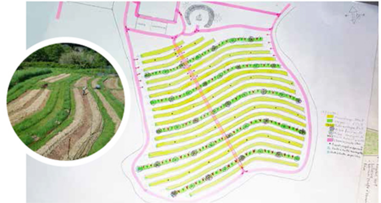
Plan préalable à l'implantation des lits de culture (en jaune et vert) qui suivent les courbes de niveau pour ralentir le ruissellement, établi par Fabien Tournan, pour le jardin pilote d'Appietto en Corse (en médaillon : les lits de culture du jardin d'Appietto).
